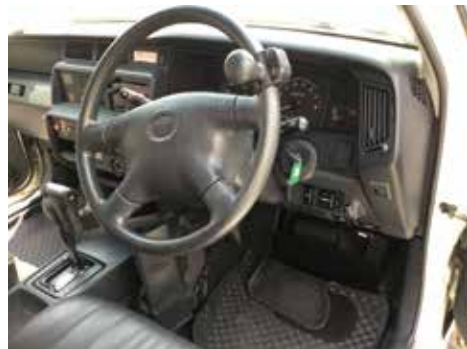
旋回式ハンドルノブ、レバー式アクセル・ブレーキを備え付けた車両
