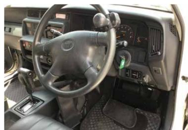
旋回式ハンドルノブ、レバー式アクセル&ブレーキを備えた車両
